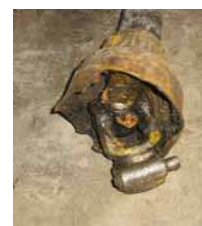
Albero cardanico con protezione rotta
