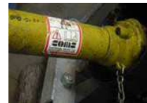
Albero cardano e presa di forza con protezioni integre
