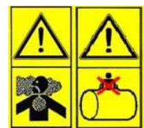
Albero cardano e presa di forza con protezioni integre
