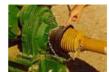
Un arbre de transmission avec sa protection intacte
