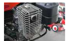
Un tuyau d'échappement isolé
