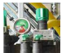
Le manomètre avec une soupape de sécurité
